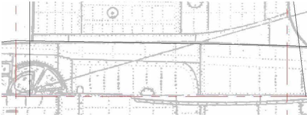
Avec l'attraction magnétique toujours activée, on matérialise les (demi)couples virtuels par des rectangles étroits que l'on trace entre les points d'intersection entre la polygone qui représente le contour du fuseau et les lignes repères de la position des couples...
