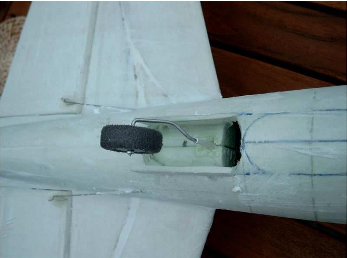
Les commandes de stab. On peut voir que le modèle complet a de nouveau été enduit de mastic ultra light dilué à l'eau et passé à la brosse pour boucher les pores de la fibre...
