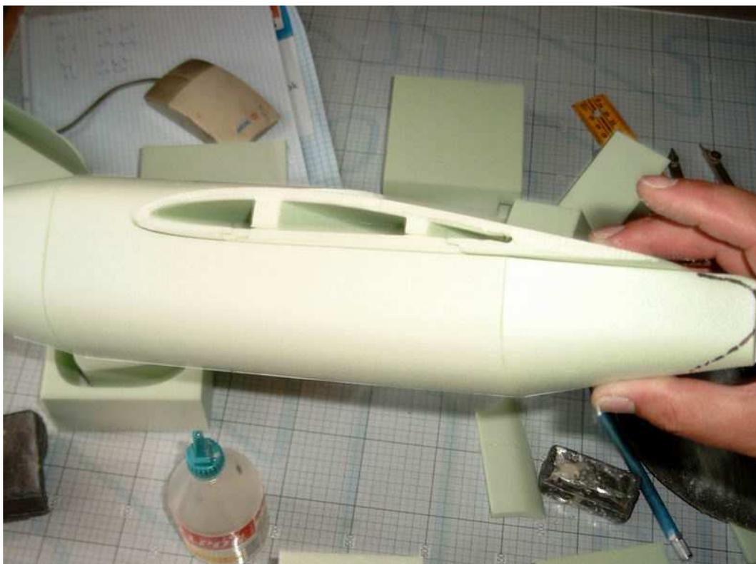
Si on réalise le train rentrant, il faut alors préparer son emplacement sur les parties centrales des ailes provisoirement assemblées.
