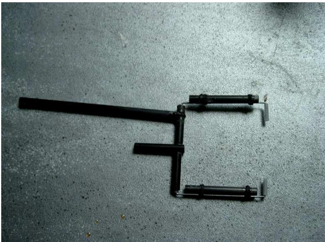
30) Idem pour le second tube et on ajuste l'écartement de l'extrémité en coinçant éventuellement des pointes de cure-dents pour obtenir environ 38mm
