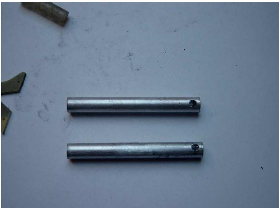
6) Percer les tubes de carbone de 78mm, à environs 3mm de chacune de leurs extrémités avec une mèche de 1 mm. Le perçage de chaque extrémité d'un même tube se fait dans un axe (diamètre) à 90° par rapport à l'autre.
