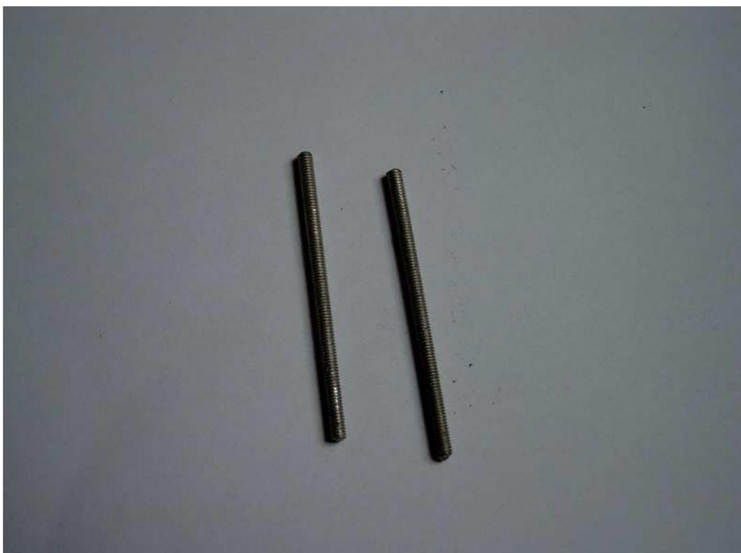
12) Tarauder les trous dans les tubes alu à M3 ou agrandissez les à 3mm si vous n'avez pas de tarauds. Passer la tige filetée dans les tubes en plaçant un écrou normal coté intérieur et un nylstop côté extérieurs.
