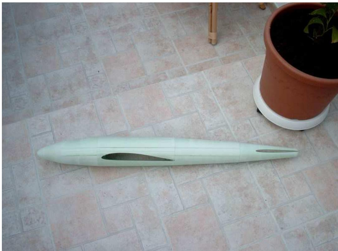
Les karman sont découpés dans des chutes et ajustés sur le fuseau avec l'aile en place protégée par une feuille de papier.
