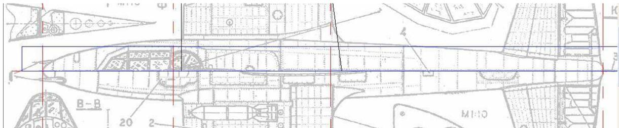
19) Si on place le couple intermédiaire sur 100 on voit que le premier tronçon pourra être réalisé traditionnellement en deux demi coquilles !
