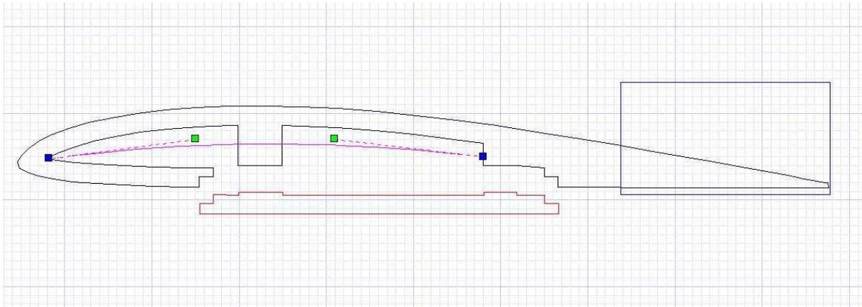
Avec l'attraction magnétique décochée je vais ramener les points de l'intérieur de l'extrados et de l'avant vers le centre tout en simplifiant le tracé (outil forme et déplacer et supprimer des points)
