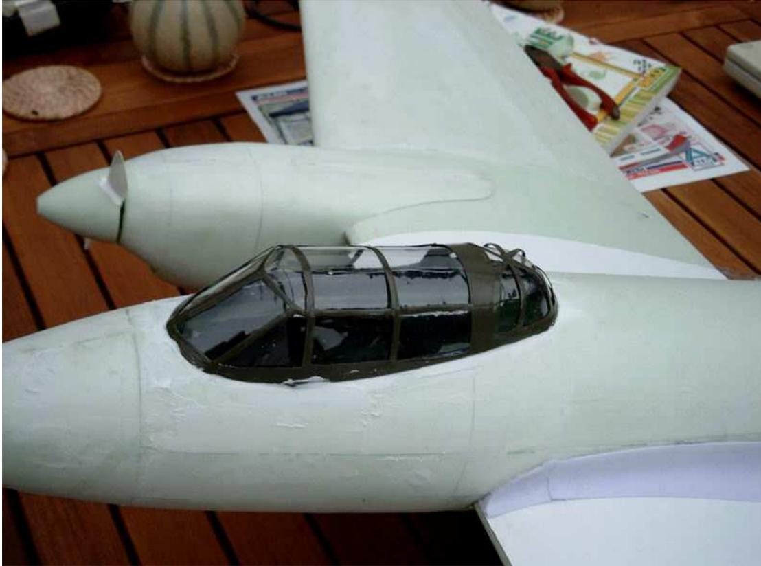
Le cockpit a aussi été collé en place ainsi que le stab. Les moteurs sont mis en place et les cônes (cylindres découpés cnc puis ponçés à la foreuse – voir mes dossiers précédents sur le site CNC@NET)
