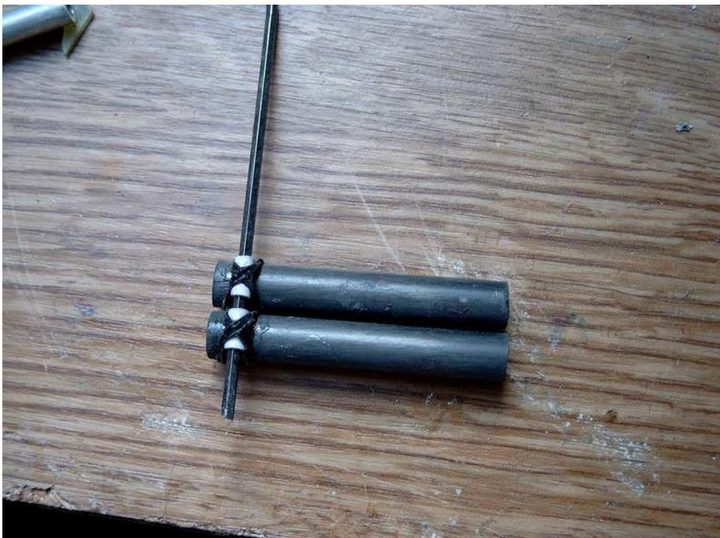
19) Insérer provisoirement une tige de 2mm dans les tubes et positionner la pièce époxy en posant le tout sur des cales pour bien aligner.
