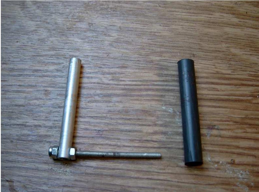
13) Écraser une extrémité d'un tube alu dans l'étau sur une longueur de 6 ou 7 mm
