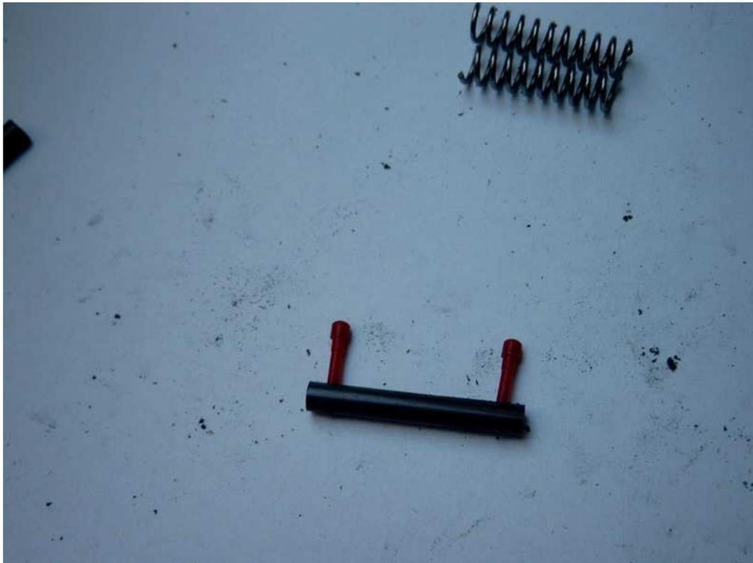
9) Un de trous de deux des tubes de 78 sera agrandi à 2mm ainsi que l'un des trous des deux tubes de 24.
