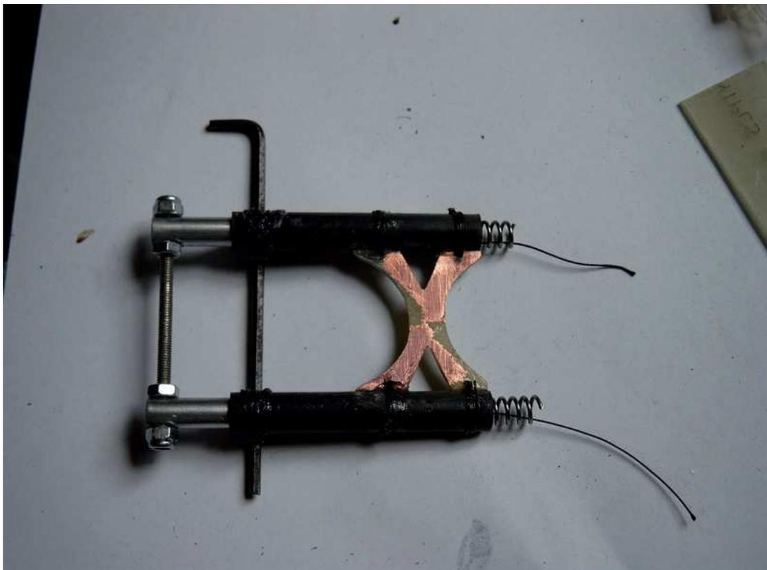
24) Insérer les deux bouts de tubes alu aplatit et percés dans le haut des amortisseurs tout en coinçant le fil ajuster de manière à ce que au repos la jambe alu sorte de 26 à 27 mm de l'amortisseur puis fixer à la cyano en vérifiant bien l'équerrage des deux pièces en leur glissant un axe au travers...
