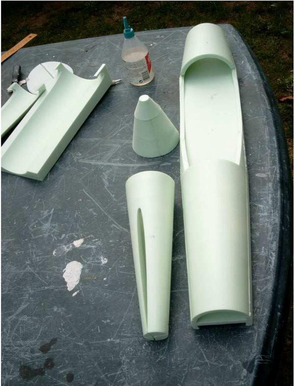
Puis les différentes parties de l'aile sont assemblées, après avoir détaché et articulés les ailerons avec du « micropore »
