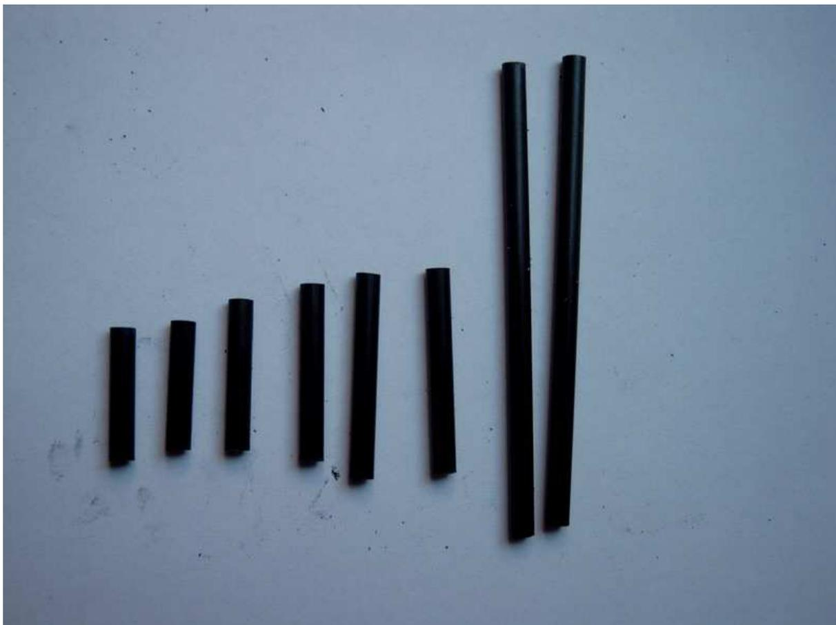
4) Préparer les bouts de durit, éventuellement avec des entailles pour que la suspension ne soit pas trop dure, ou les ressorts de 20mm.
