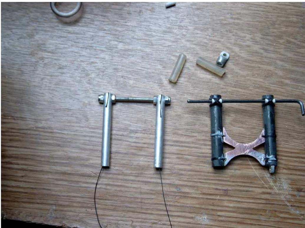
23) Enfiler les morceaux de durit ou les ressorts sur les fils et rentre le tout dans les jambes en carbone.
