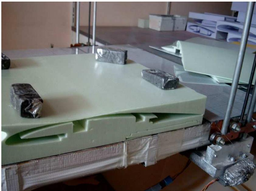
Malgré un réglage fin de la chauffe, il se peut que vous obteniez comme moi une légère déformation de l'extrémité des ailes due à la forte conicité !
