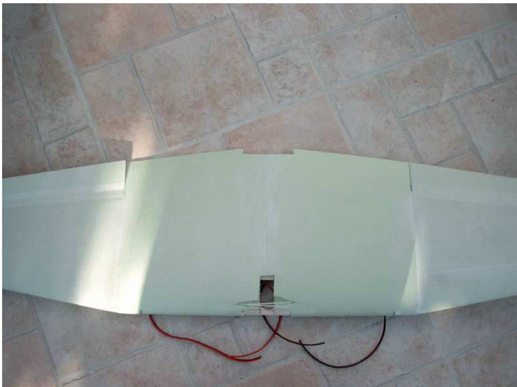
Les gaines des trains rentrant avaient été préalablement installées, ainsi que les servos d'ailerons et leurs câbles et les câbles d'alimentation moteurs et éventuellement les câbles prévus pour les contrôleurs (au cas on installerait deux brushless avec leur contrôleur dans les nacelles) ...
