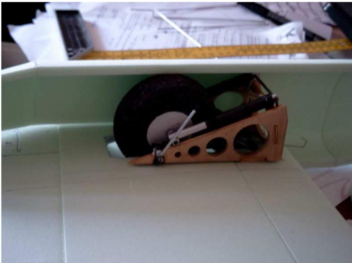
Ajuster la position train rentré et sorti, et installer les gaines de commandes...
