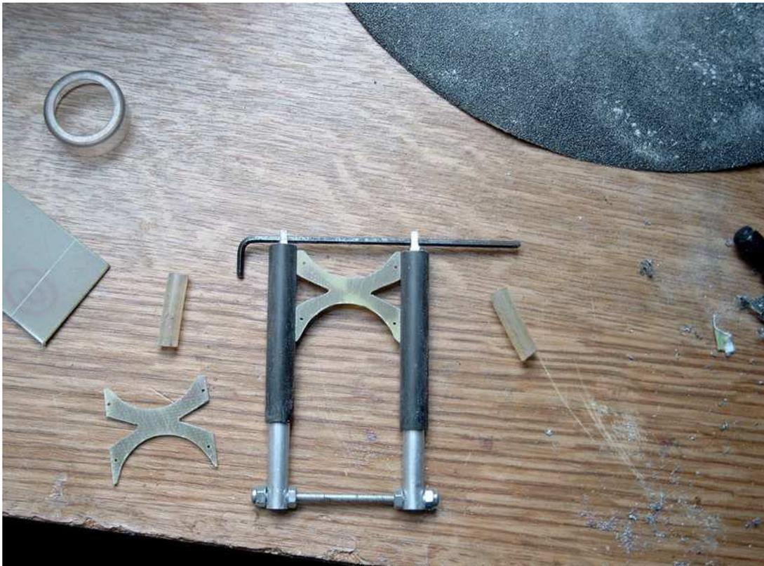
17) Assembler un petit morceau de tube plastique 2x3mm sur le bas des tubes carbone au moyen d'un brellage avec le fil à coudre (bien serrer tout le fil sans trop dépasser à l'extérieur du tube carbone !)
