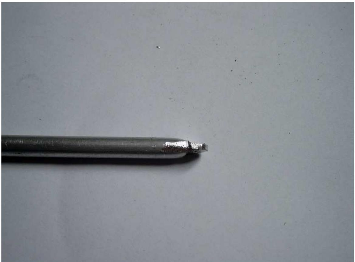
15) couper le tube en lui conservant us longueur cylindrique de 5mm, et ajuster à la lime pour qu'elle rentre sans forcer dans l'extrémité du tube carbone
